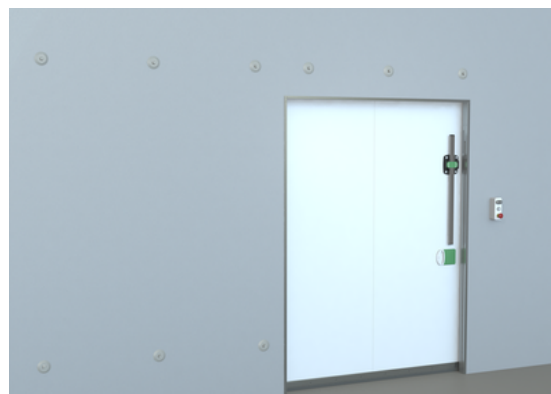
Kuva 14: Käsikäyttöinen liukuovi lisävarusteltu konekäytöllä, sisänäkymä. HUOMAUTUS: kuvassa myös erikseen optiona toimitettavissa oleva kuvan 15 avaus- / hätäseis- / sulku- / puoliavauskytkin.
