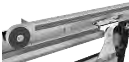
Kuva 9: Hammashihna, johtopyörä ja hammashihnan kiinityskorvake ovilehden yläkanttiin
